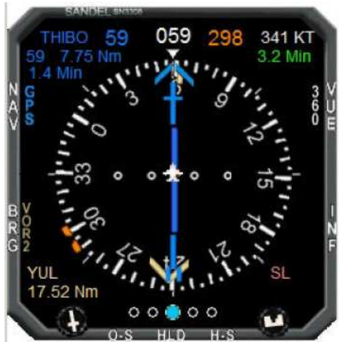
Nous avons cliqué sur le bouton OS pour re-synchroniser l'indicateur de cap GPS
